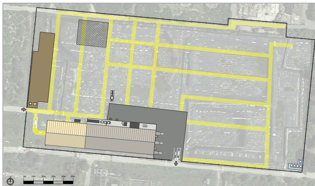
Figura 4.3 - Planimetria dell'Area Palte con evidenziate in giallo le piste di cantiere.
