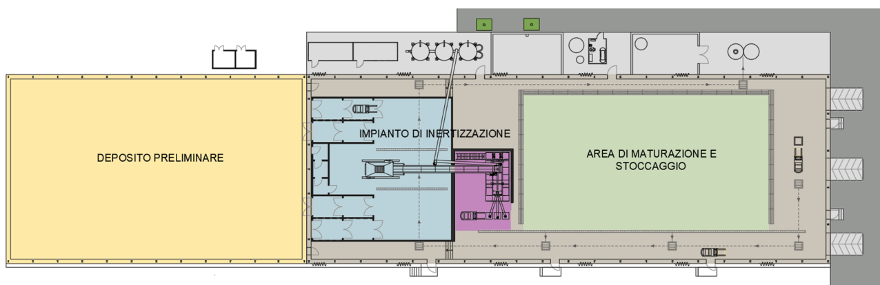
Figura 5-3 - Planimetrie "Deposito Preliminare" e "Capannone Impianto" con ubicazione dell'Impianto di Inertizzazione e dell'Area di Maturazione e Stoccaggio
